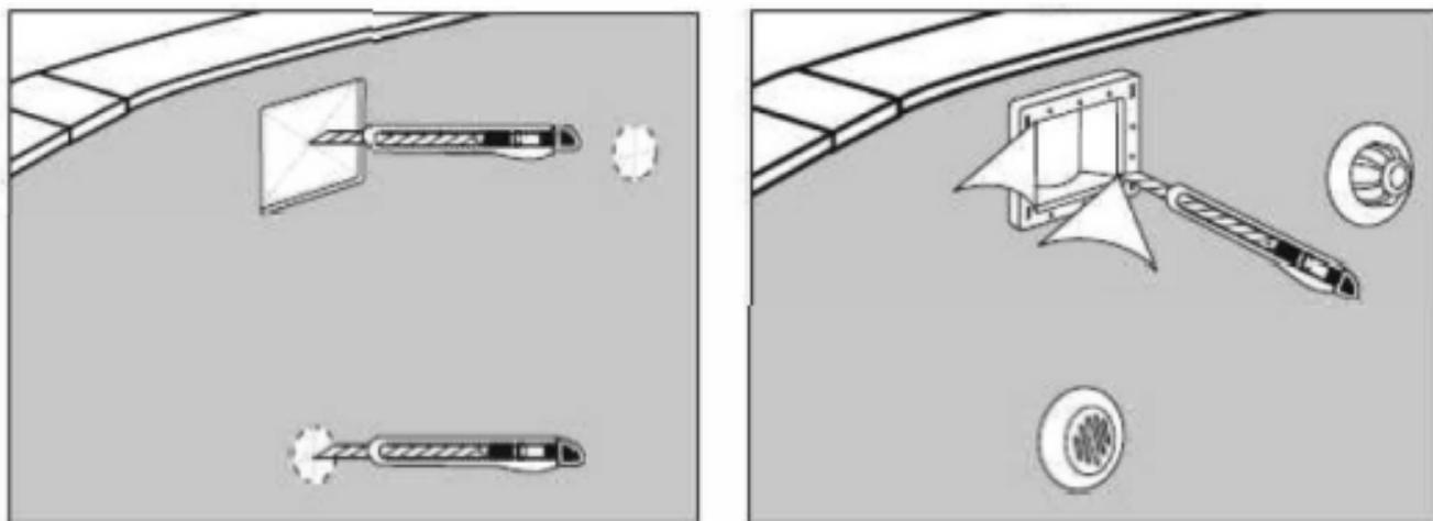
Remplissez le bassin d'eau jusqu'à 5 cm en dessous de la pièce concernée (buse de refoulement ou skimmer, etc.), puis arrêtez le remplissage et réalisez les découpes avec un cutter bien aiguisé.
